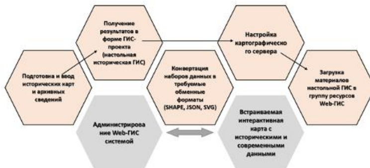
Рис. 1. Технологическая схема создания и использования исторической web-ГИС на платформе NextGIS Web
